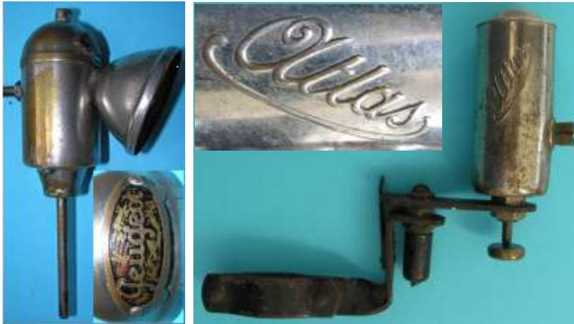
Bild 1.4: Reibrad unterhalb des Dynamokörpers bei den Typen „Peugeot“ und „Atlas“
