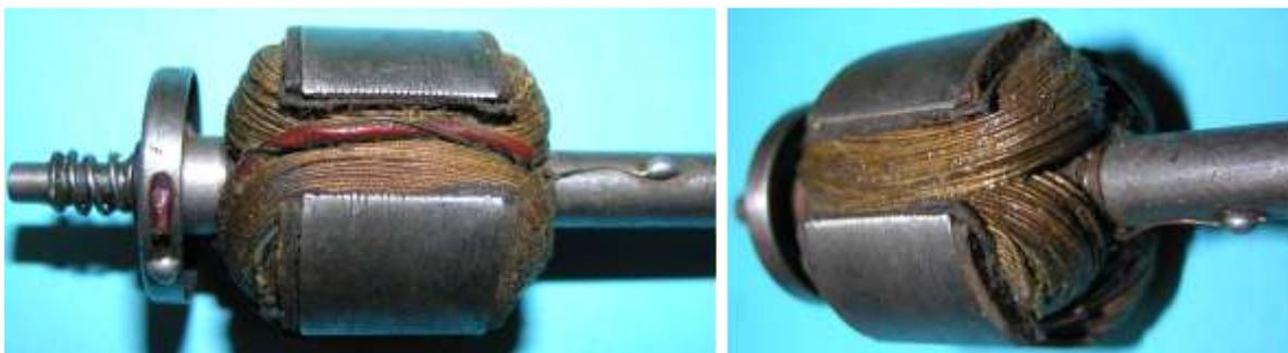
Bild 5.31: Bewickelter Anker mit den zwei Lötstellen, der Schleifscheibe und der Axialdruckfeder
