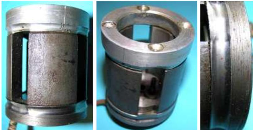
Bild 5.30: Erregersystem mit vier Stabmagneten:
