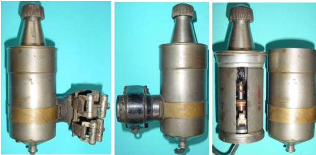
Bild 4.3: RL1a: a) Dynamo mit Kippvorrichtung und Halterung, b) Abgenommener Gehäusetopf (Aus der Sammlung Frank Schellenberg, Seckmauern)
