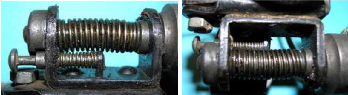
Bild 5.25: Sperrbolzen in seiner Halterung
