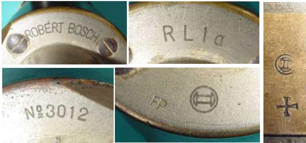
Bild 4.5: Kennzeichnungen auf dem Lagerhalsfuß und dem Spannband
