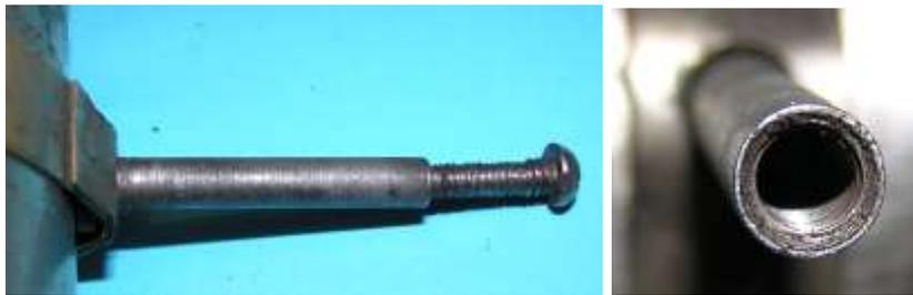
Bild 5.26: Spannbandbolzen mit Innengewinde und Spannschraube
