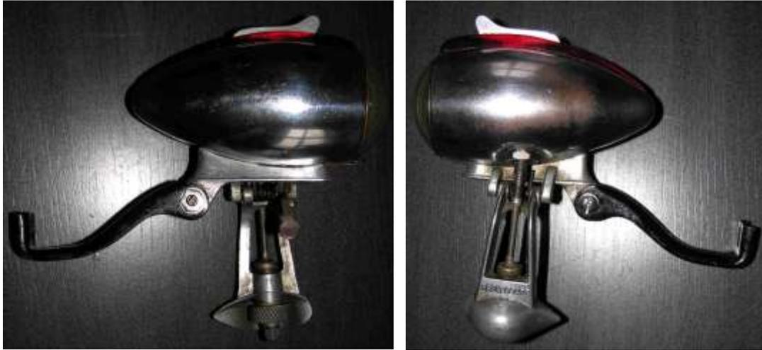
Bild 2.8: Dynamo-Lampen-Kombination angetrieben durch eine biegsame Welle
