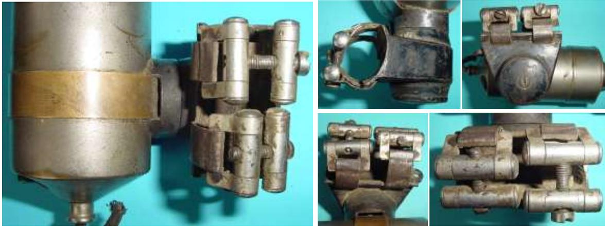
Bild 4.11: Spannbandbefestigung der Kippvorrichtung am Gehäusemantel und Ansichten der Halterung mit der Kippvorrichtung
