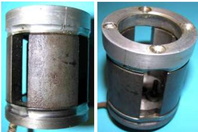
Bild 1.12: Erregersystem bestehend aus einem Jochteller und vier Stabmagneten
