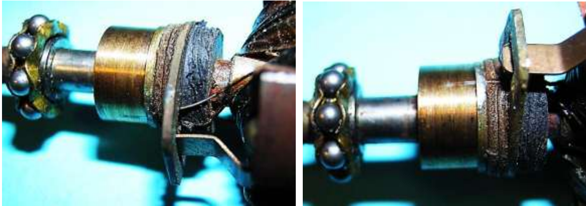
Bild 2.14: Schleifring, Spulenanschlüsse und Kontakte des Fliehkraftreglers
