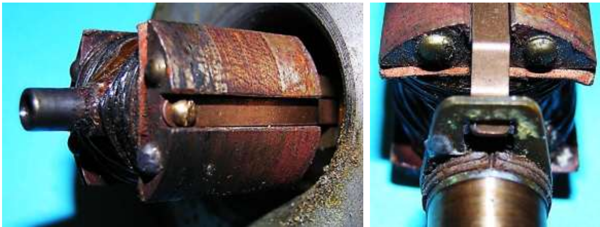
Bild 2.15: Kontakte des Fliehkraftreglers: a) Befestigung der Fliehkraftfeder in der Nut eines der beiden Polschuhe, b) Isolierter Anschluss der Hilfswicklung
