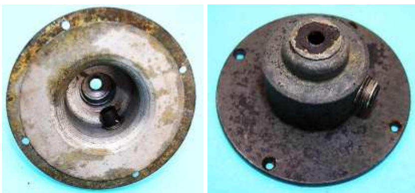
Bild 2.5: Lagerhals: a) Innere Ansicht mit Kugellagerring und Bürstenhalter, b) Äußere Ansicht mit Bürstenhalter
