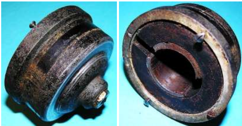
Bild 2.4: Gehäusetopf: a) Mantel und Boden, b) Eingesetztes Erregersystem
