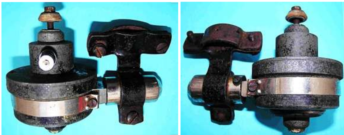
Bild 1.1: Seitenansichten des ASTE-Dynamos
