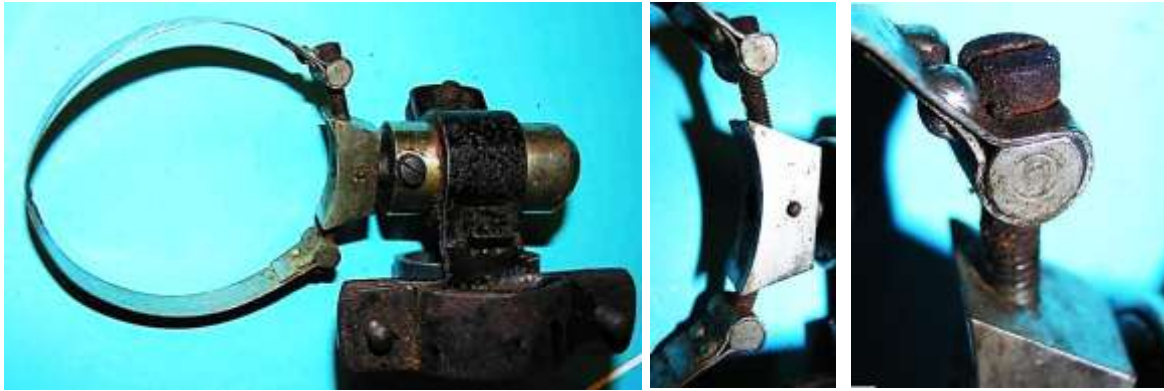
Bild 2.3: Spannbandbefestigung: a) Spannband mit Drehbolzenaufsatz mit zwei Gewindebolzen, c) Spannbandende mit Spannbolzen
