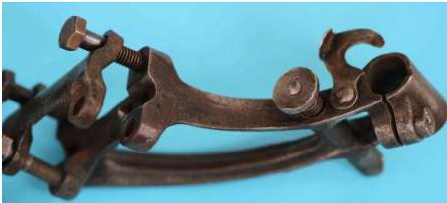
Bild 2.6: Halter mit Sperrstift und Sicherungsschuh
