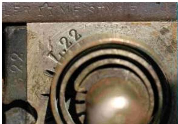
Bild 2.4: Nuten zur Verstellung der Federkraft,
