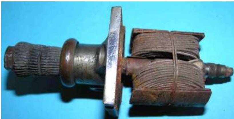
Bild 1.24: Läufer mit Lagerhals
