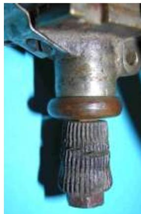
Bild 1.12: Reibrad oder Grundkörper des Reibrades:
