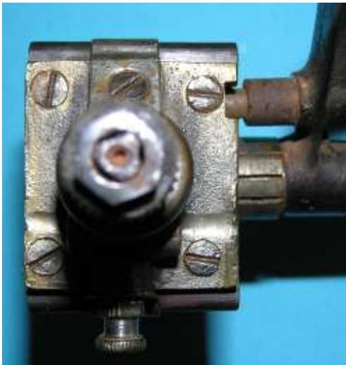
Bild 1.19: Befestigung des Lagerhalses an den Polschuhen mit vier Schrauben
