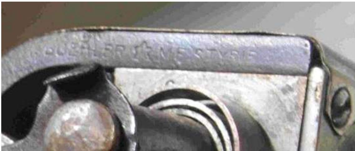
Bild 1.7: Eingprägtes Schriftband beim ELO-L22: „Böhler (6-zackiger Stern) ME STYRIE“
