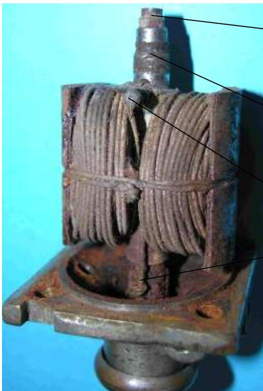
Spannung führender Schleifkontakt
