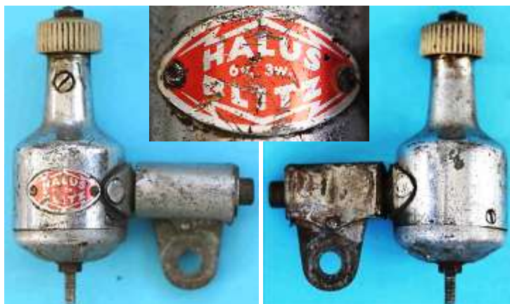
Bild 4.2: Halus Blitz mit Lager- halstopf (Nr.3.1)
