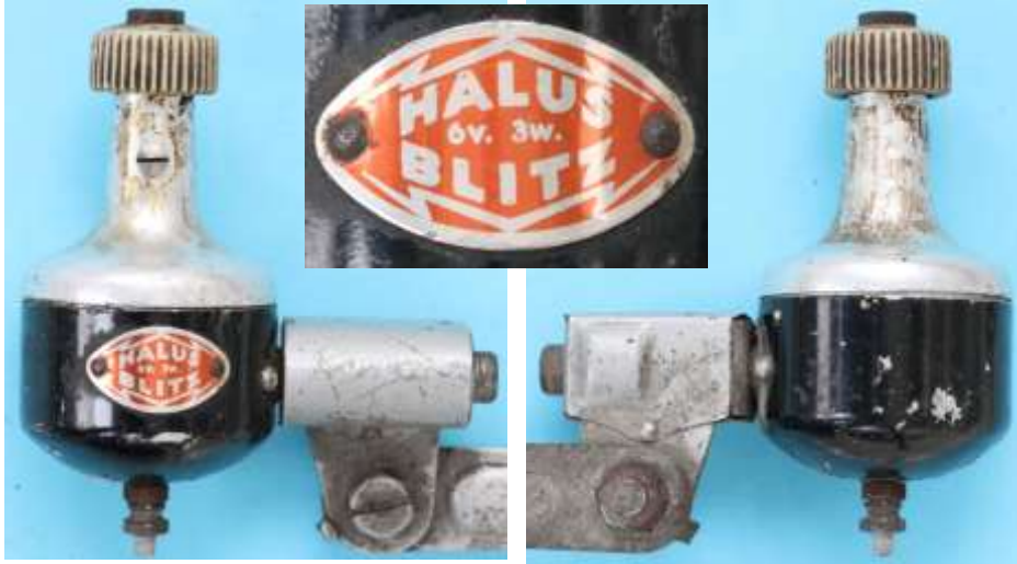
Bild 4.10: Zweites Gehäusekonzept von Halus Blitz
