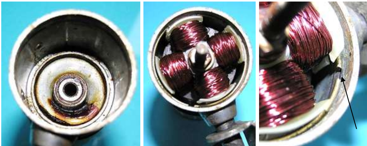
Bild 6.5: Lagerhalstopf: a) Im Lagerhalstopf eingesetzten Lagerteller, b) Vierpoliger Anker im Lagerhalstopf, c) Offener Drahring zur axialen Sicherung des Ankersitzes
