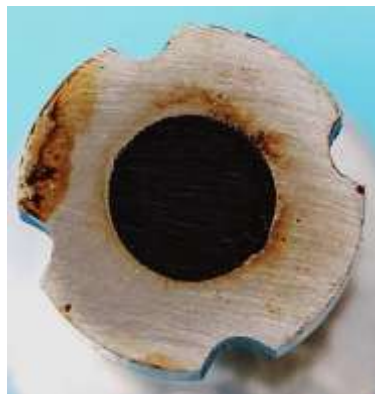
Bild 4.13: Vierpoliges Polrad, Durchmesser 30 mm, axiale Länge 13 mm a) Welleneinsatz b) Abschluss der Wellenbohrung
