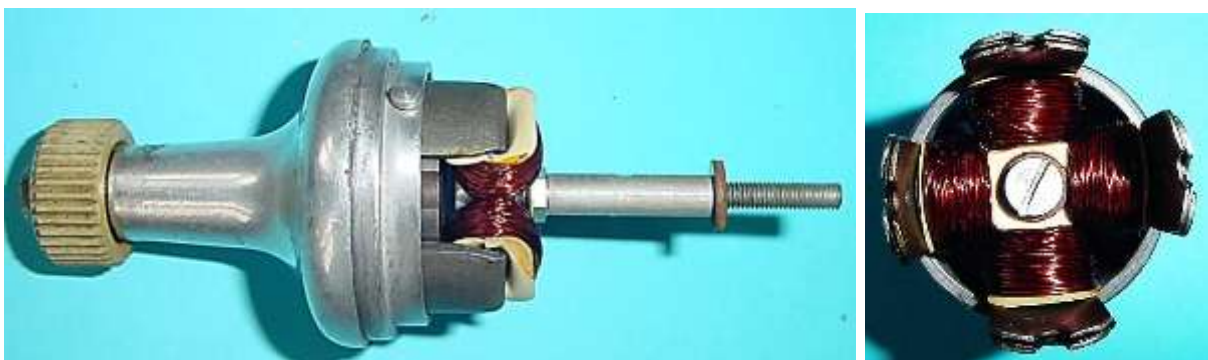
Bild 3.8: Generator und Lagerhals a) Positionierung des Generators im Lagerhals; b) Vierpoliger Blätterpolanker
