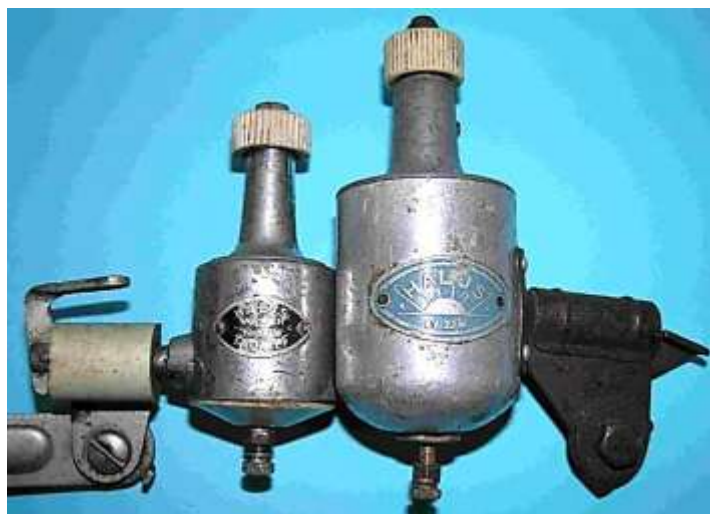
Bild 6.2: Demonstration des Entwicklungssprungs durch die Ablösung des Magnetstahls durch AlNi-Magnete oder durch keramische Magnete.
