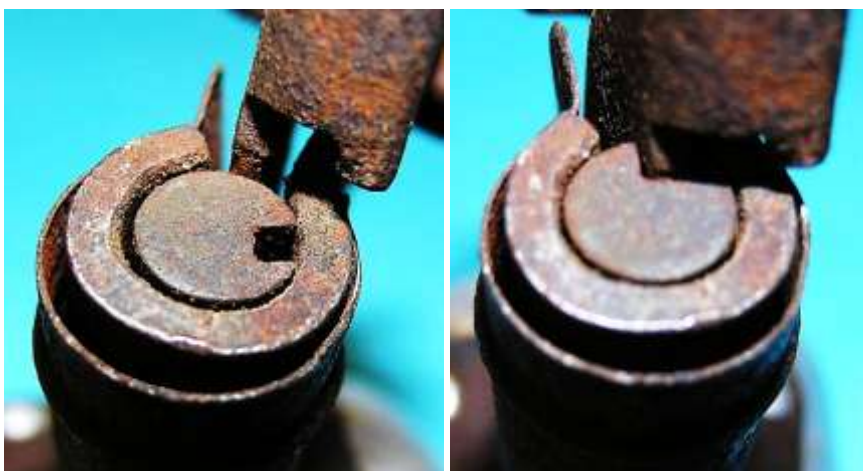
Bild 2.5: Nut im Dreh- bolzen zum Einrasten der Klinke: a) Betriebsstellung b) Ruhestellung
