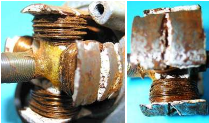
Bild 2.14: Anker: a) Sicherung der Bauteile auf der Welle durch Kleber, b) Ausbildung der Polflächen durch zwei in axialer Richtung abgewinkelten Blechen
