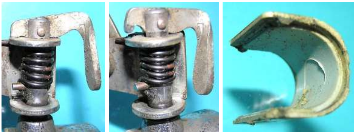
Bild 6.7: Kippvorrichtung: a) Eingerasteter Fußhebel, b) Betriebsstellung der Kippvorrichtung, c) Thermoplastische Abdeckung
