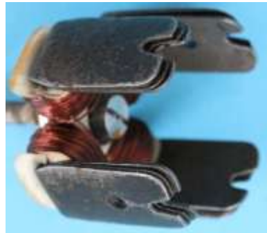
Bild 4.14: Anker: a) Anker mit Kabelbolzen, b) Kontur der Blätterpole, c) Mit drei Blechen verstärktes Joch
