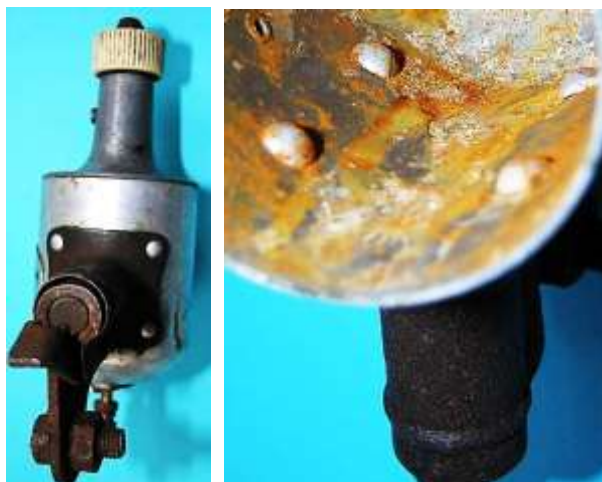
Bild 2.2: Befestigung der Kippeinrichtung a) Angenieteter Flansch, b) Erhabene Niete innerhalb des Gehäusetopfes
