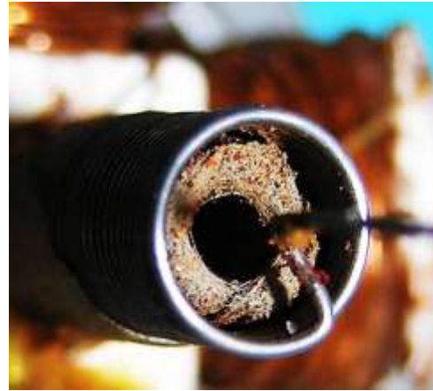
Bild 2.11: Schraubenfeder mit abgewinkeltm Ende: a) Position am Wellenende, b) Befestigung auf einen Isolierkörper
