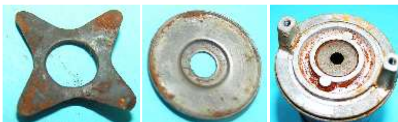
Bild 2.16: Axialspieleinstellung: a) Blattfeder, b) Andruckteller, c) Lagerhalsfuß mit Gleitbahn
