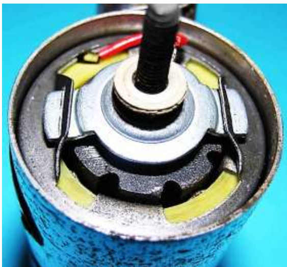
Bild 7.2: Anker, Polrad und Lagerschild bei abgenommenem Boden
