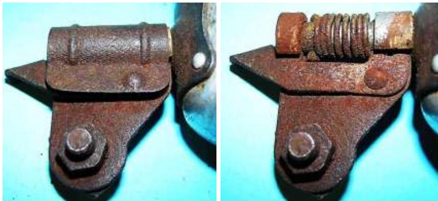
Bild 2.4: Seitenansicht der Kippeinrichtung: a) Mit Abdeckung, b) Ohne Abdeckung
