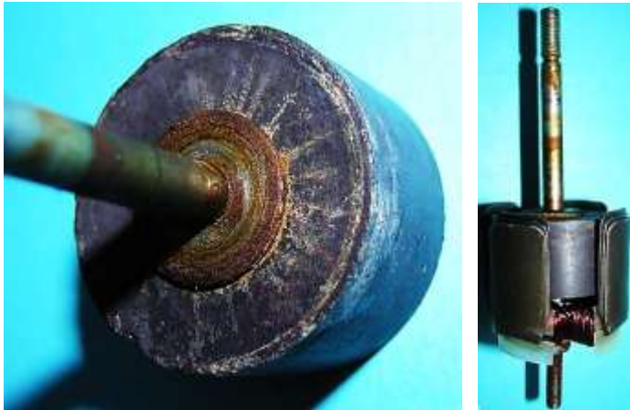
Bild 6.3: Polrad: a) Walzenmagnet, b) Walzenmagnet im Blätterpol- anker
