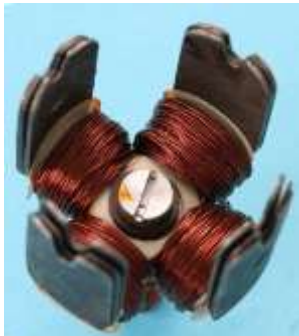
Bild 4.14: Anker: a) Anker mit Kabelbolzen, b) Kontur der Blätterpole, c) Mit drei Blechen verstärktes Joch
