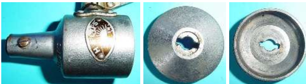
Bild 5.5: Lagerhals und Boden
