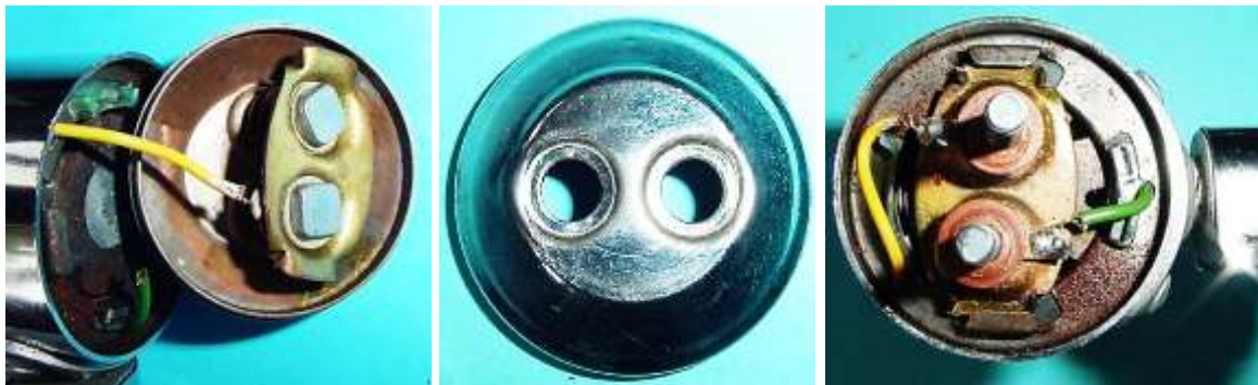
Bild 8.5: Kontakte: a) Bodendurchführung der zwei Kabelbolzen, b) Boden, c) Befestigung des Kontaktstegs durch zwei angeschnittene Blechlaschen
