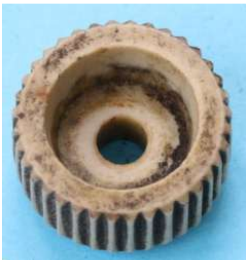
Bild 4.16: Keramikreibrad ohne Konturen für die Verdrehsicherung zwischen den Kontermuttern
