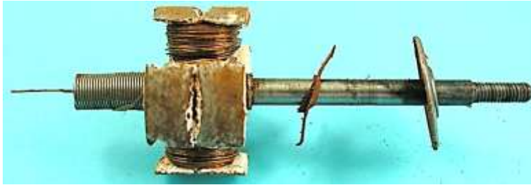
Bild 2.13: Anker mit Welle und Axialspielausgleich
