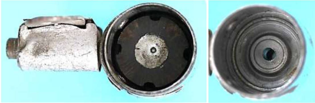
Bild 4.8: Lagerhalstopf: a) Polrad im Lagerhalstopf, b) Unteres Gleitlager
