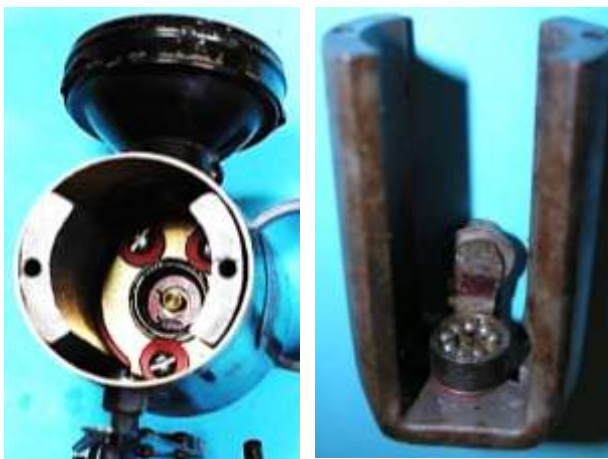
Bild 2.2: Magnetsystem im Lakjer: a) Eingebaut im Gehäusetopf b) Tulpenmagnet mit Kugellager
