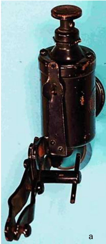
Bild 4.12: Blattfeder zur Arretierung in der Ruhestellung a) Kippvorrichtung am Lakjer 75683 b) Darstellung der Kippvorrichtung im Patent / 4/
