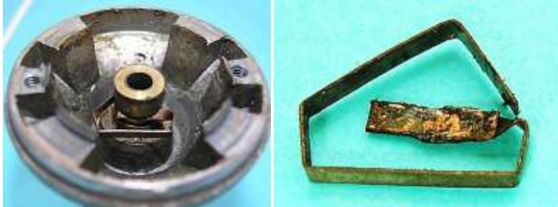
Bild 5.13: Blattfeder zur elektrischen Überbrückung des Gleitlagers
