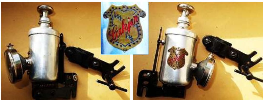
Bild 4.1: Zweipoliger Tulpenmagnet-Dynamo mit Diebstahlsicherung
