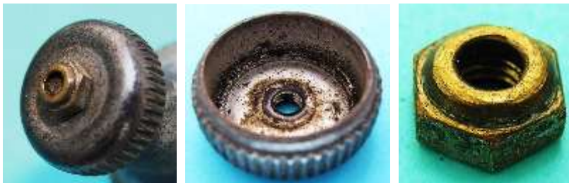
Bild 5.18: Reibradgestaltung und Befestigung auf der Welle
