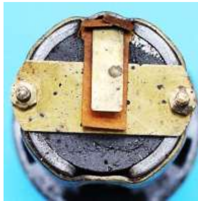
Bild 5.8: Fixierung der ferromagnetischen Polstäbe an der Magnetscheibe: a) Messingring, Fertigungsnummer 507801, b) Aluminiumtopf, Fertigungsnummer 587232
