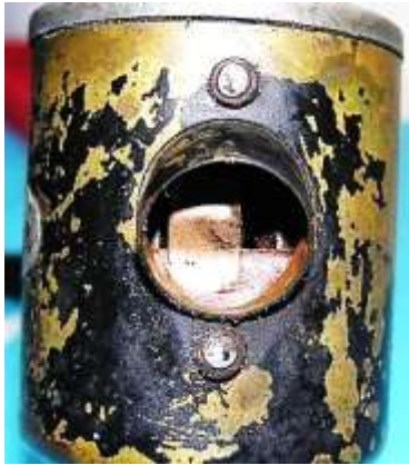
Bild 6.3: Lampengehäuse: a) Gehäusetopf mit angenietetem Stutzen, b) Lampengehäuse, c) Fassung für den Glühbirnensockel
