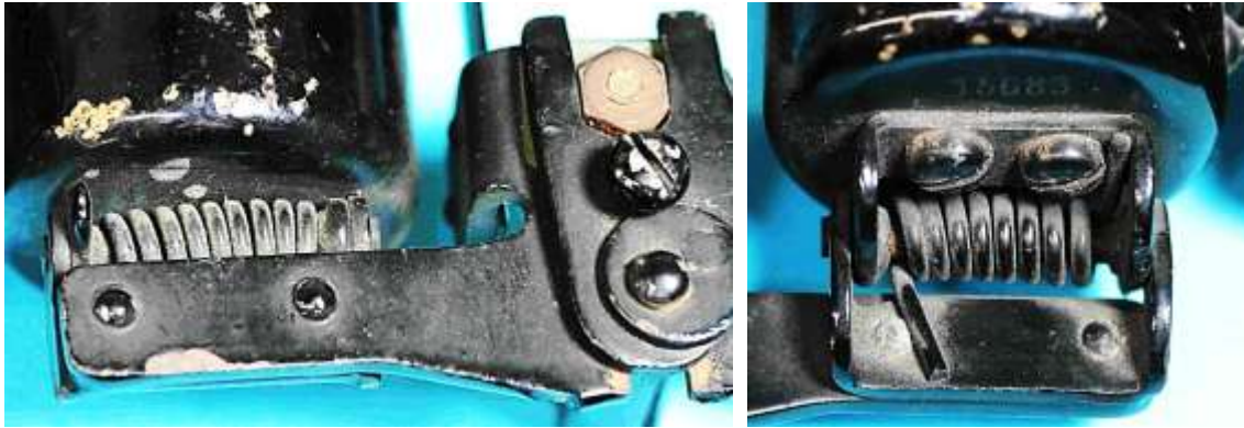
Bild 4.11: Kippvorrichtung: a) Druckfeder mit Zwischenstück des Halters, b) Gelenk unterhalb des Bodens
