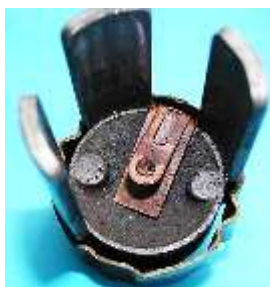
Bild 5.9: Spannung führende Blattfeder: a) und b) Teil der Blattfeder, der mit der Wellenkappe in Berührung kommt, c) Kontaktfeder mit Isolierung, d) Kontaktfeder und Magnet
