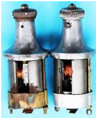
Bild 5.8: Fixierung der ferromagnetischen Polstäbe an der Magnetscheibe: a) Messingring, Fertigungsnummer 507801, b) Aluminiumtopf, Fertigungsnummer 587232
