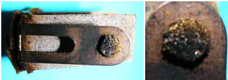
Bild 5.11: Drahtbündel (Bürste) als Kontaktfläche für die Spannung führende Kappe auf dem Wellenende
