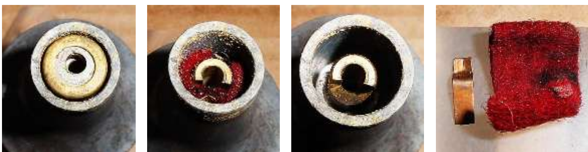
Bild 5.15: Schmierung des Gleitlagers
