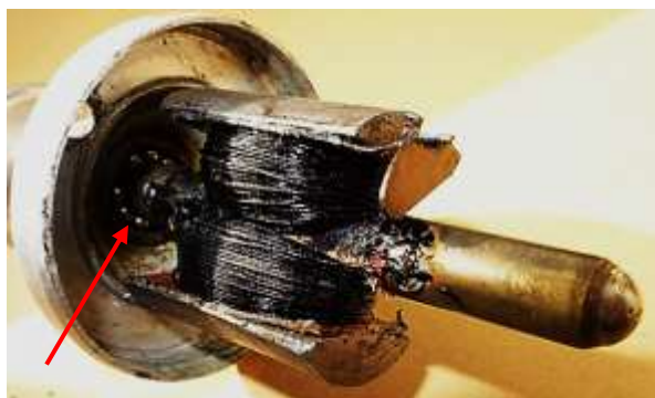
Bild 4.6: Anker: a) Oberes Kugellager und Lötstelle des Spannung führenden Spulenendes, b) Schaltkontakt und Spulenanschluss
