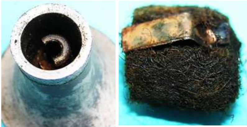
Bild 5.16: Öldepot mit Kontaktfeder
