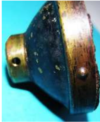
Bild 6.3: Lampengehäuse: a) Gehäusetopf mit angenietetem Stutzen, b) Lampengehäuse, c) Fassung für den Glühbirnensockel
