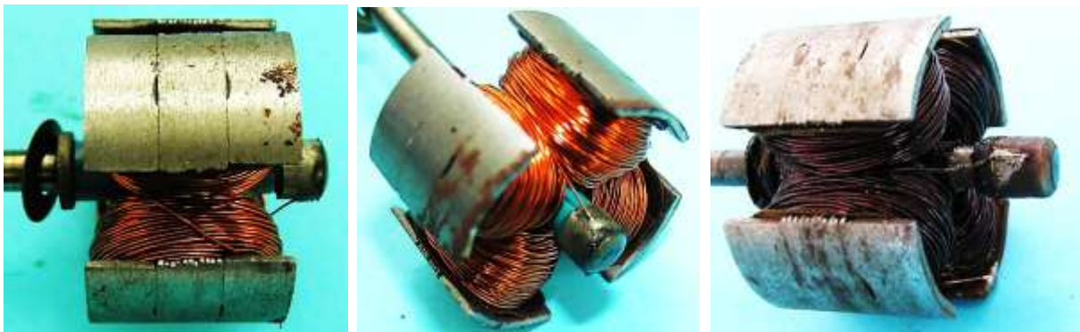
Bild 8.4: Läufer mit verkürztem Wellenende: a) und b) Anker mit verkürztem Wellenende c) Anker der Modelle L und D
