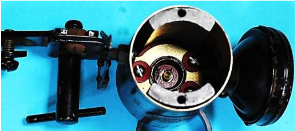
Bild 4.13: Knebelmutter für die schnelle Demontage und zweipoliger Tulpenmagnetdynamo
