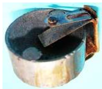
Bild 5.9: Spannung führende Blattfeder: a) und b) Teil der Blattfeder, der mit der Wellenkappe in Berührung kommt, c) Kontaktfeder mit Isolierung, d) Kontaktfeder und Magnet
