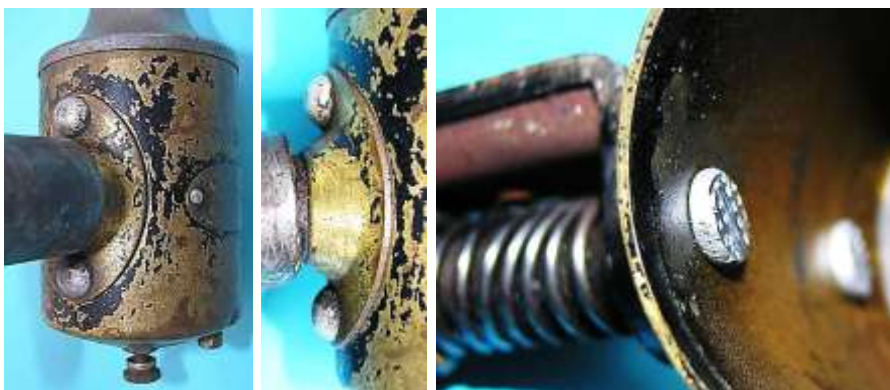
Bild 5.2: Befestigung des Flansches der Kippeinrichtung
