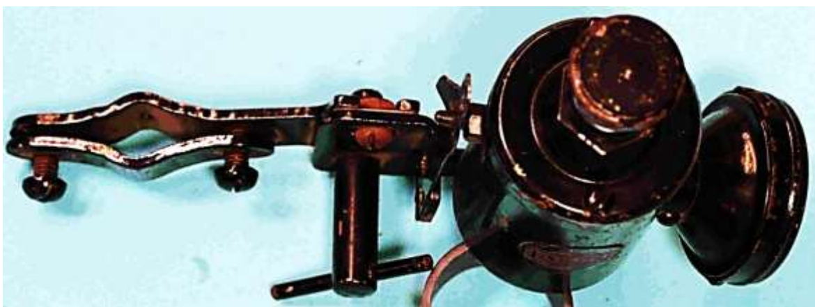
Bild 4.10: Blick von oben auf die Halte- und Kippvorrichtung sowie auf den Lagerhalsfuß und die Lampe
