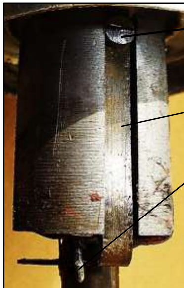
Bild 4.4: Polschuh mit Fliehkraftschalter
