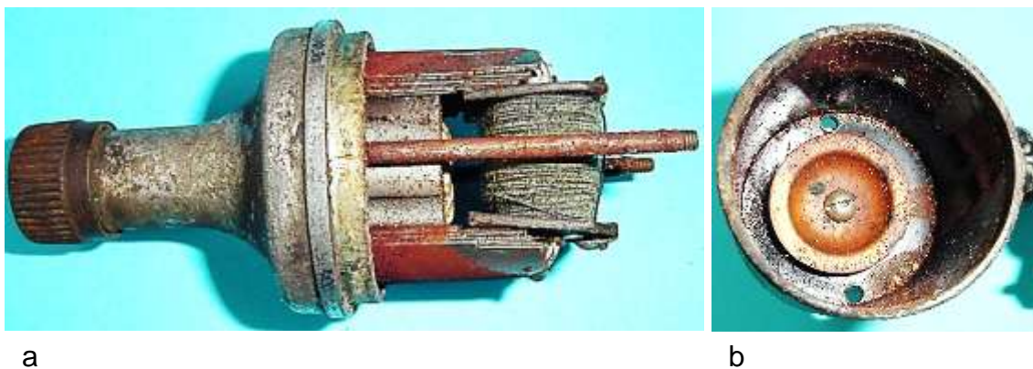
Bild 2.2: Bauteile des Dynamos: a) Lagerhals mit den Generatorelemente, b) Innenraum des Gehäusetopfes
