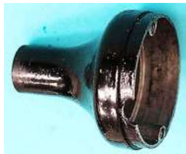
Bild 2.37: Zusammenfügen der Gehäuseteile: a) Lagerhals mit zweiteiligem Gleitlager, b) Lagerhalsrand mit Nut, c) Flansch innerhalb des Gehäusetopfes
