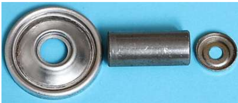
Bild 5.9:: Einzelteile des Lagers a) Lagerschild b) Gleitlagerrohr c) Schutzkappe
