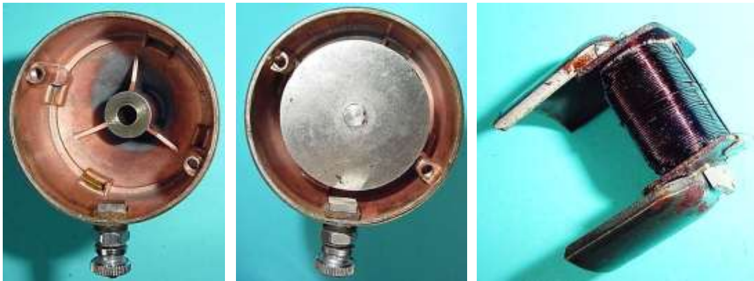
Bild 4.18: Lagerhalstopf: a) Lagerhalstopf mit unterem Gleitlager, b) Walzenläufer im Lagerhalstopf, c) Ankerspule mit Ankereisen
