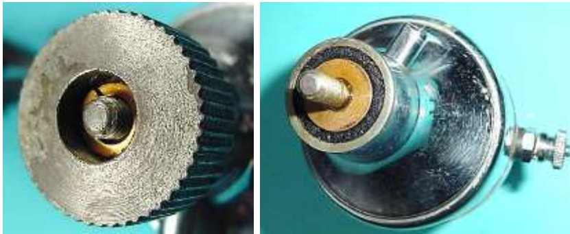
Bild 4.8: Reibrad und Ankerwelle mit Gewinde
