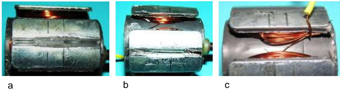
Bild 6.10: Polschuhflächen: a) Mit Kunststoff ausgefüllte Kerbe in der Polmitte, b) Vom Kunststoff gereinigte Kerbe, c) Ohne Drahtunterbrechung gewickelte Spulen
