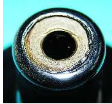
Bild 6.14: Stahlgussreibrad: a) Versenkte Kontermutter, b) Lauffläche, c) Vom Reibrad abgedeckte Stirnfläche des Gleitlagers
