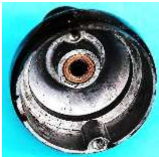
Bild 2.37: Zusammenfügen der Gehäuseteile: a) Lagerhals mit zweiteiligem Gleitlager, b) Lagerhalsrand mit Nut, c) Flansch innerhalb des Gehäusetopfes
