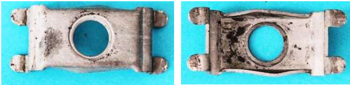
Bild 3.13: Kontaktsteg mit zentraler Bohrung und Befestigungslaschen
