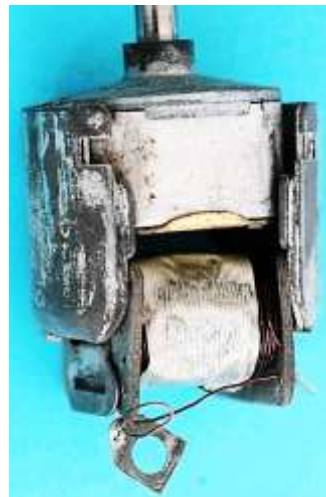
Bild 3.12: Generator: a) Polschuhe im Lagerhalsfuß eingeklinkt, b) Anker und Polrad ohne Lagerhals
