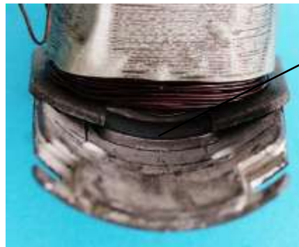
Bild 3.11: Anker: a) Ankerpole mit Wicklung, b) Ankerpolfläche
