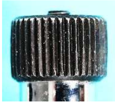
Bild 6.14: Stahlgussreibrad: a) Versenkte Kontermutter, b) Lauffläche, c) Vom Reibrad abgedeckte Stirnfläche des Gleitlagers
