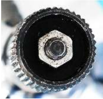
Bild 6.14: Stahlgussreibrad: a) Versenkte Kontermutter, b) Lauffläche, c) Vom Reibrad abgedeckte Stirnfläche des Gleitlagers
