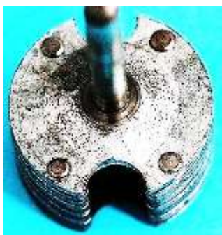
Bild 2.38: Polrad: a) Wellenteller mit Welle, b) Blockmagnet mit geblechten Polschuhen, c) Befestigung der Welle am Wellenteller
