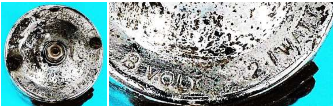
Bild 2.30: Beschriftung des Bodens mit den Nenndaten 8 V und 2,1 W
