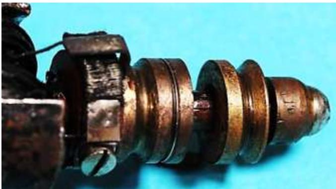
Bild 6: Befestigung der mit Widerstandsdraht umwickelten Blattfeder auf dem Kunststoffkörper
