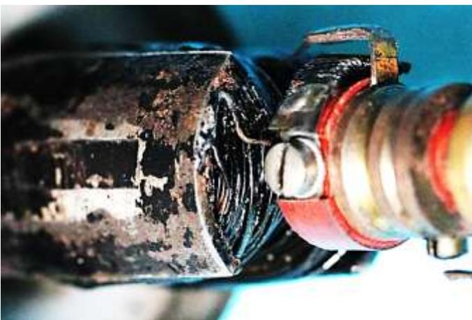
Bild 7: Masseverbindung zwischen dem Widerstandsdraht und dem Polblech
