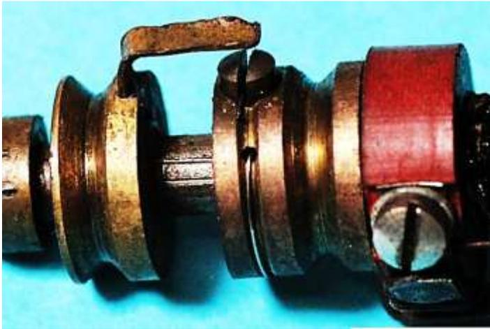
Bild 9: Ringförmige Drahtfeder des Fliehkraftschalters
