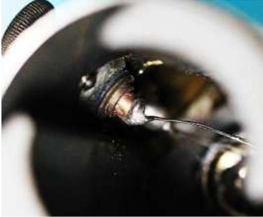
Bild 5: Lötstelle am Spannung führenden Kabelanschlussbolzen
