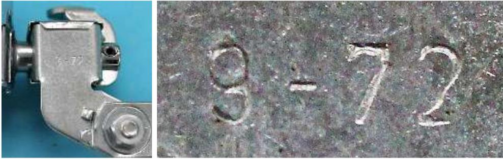
Bild 3.29: Fertigungsdatum September 1972 auf der Rückseite der Kippvorrichtung
