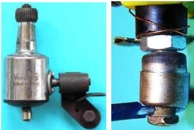
Bild 3.21: Dynamomarkte „Vordana“ mit der Federdruckklemme des Dansi-Musters 4
