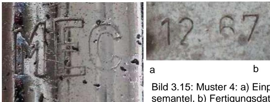
Bild 3.15: Muster 4: a) Einprägung auf dem Gehäusemantel, b) Fertigungsdatum auf dem Basisblech
