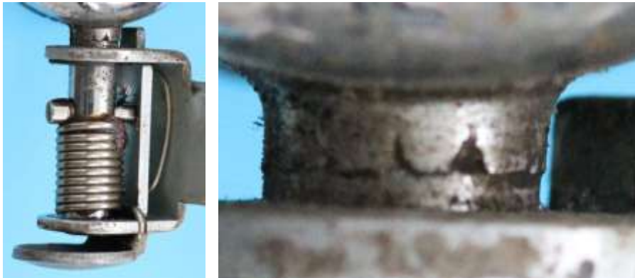
Bild 2.1: Befestigung des Drehbolzens am Gehäusetopf
