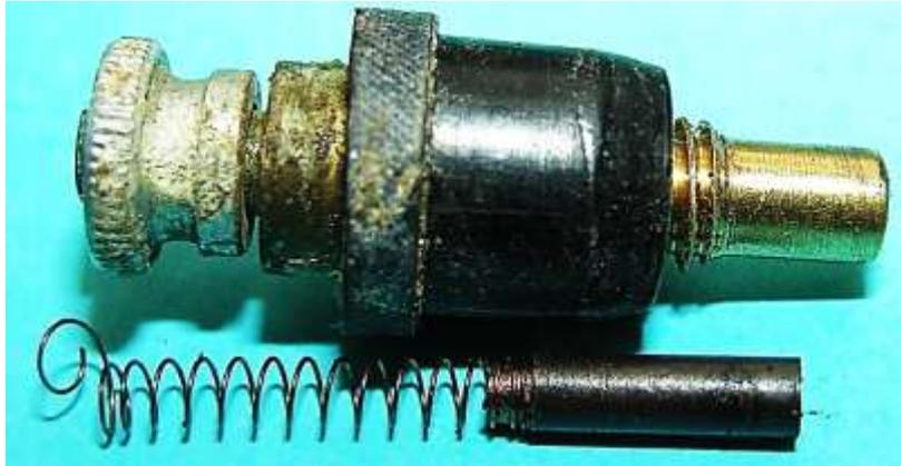
Bild 2.13: Kabelanschluss mit Bürstenhalter
