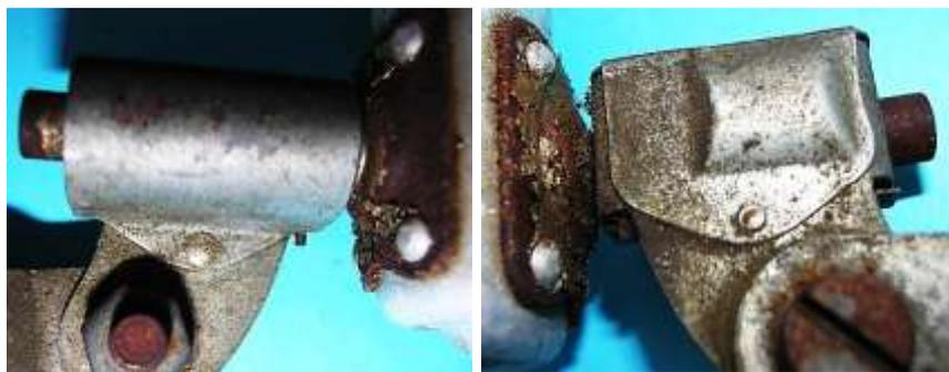
Bild 2.3: Fest vernietete Abdeckung der Kippvorrichtung
