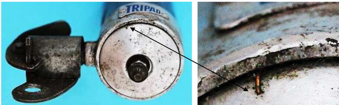
Bild 3.3: Masseanschluss
